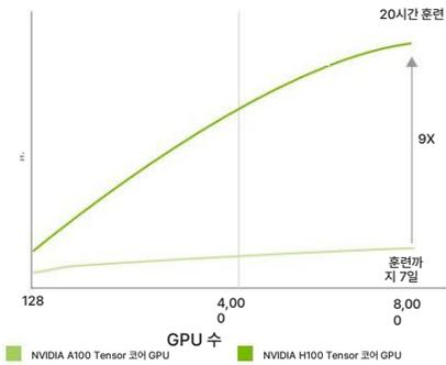
예상 실적은 변경될 수 있습니다. 1T 토큰 데이터 세트에서 395B 매개변수가 포함된 MoE(전문가 혼합) Transformer Switch-XXL 변형 | A100 클러스터: HDR IB 네트 워크 | H100 클러스터: NVLink 스위치 시스템, NDR IB
