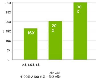
예상 실적은 변경될 수 있습니다. 입력 시퀀스 길이=128, 출력 시퀀스 길이=20에 대한 Megatron 530B 매개변수 모델 챗봇에 대한 추론 | A100 클러스터: HDR IB 네트 워크 | H100 클러스터: 16개의 H100 구성을 위한 NDR IB 네트워크 | 3 2 A100 vs 16 H100 1초 및 1.5초 | 16 A100
