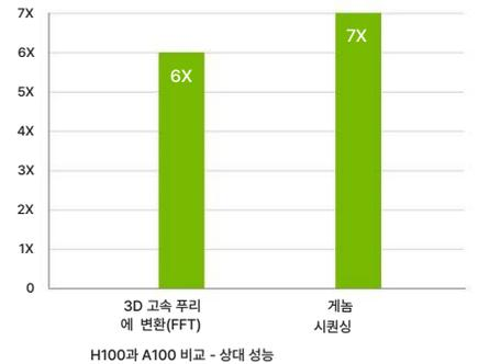
예상 실적은 변경될 수 있습니다. 3D FFT(4K\*3) 처리량 | A100 클러스터: HDR IB 네트워크 | H100 클러스터: NVLink 스위치 시스템, NDR IB | 계능 시뮬레이션(Smith Waterman) | 1 A100 | 1H100
